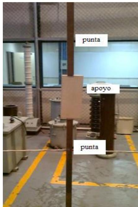
**Figura 4.4** Arreglo configuración punta-punta.
