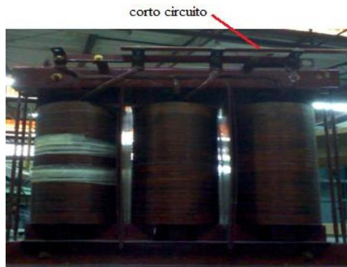
**Figura 4.17** Corto circuito de la conexión estrella en baja tensión de transformador.
